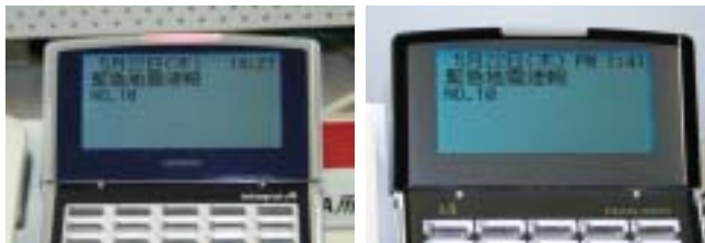
写真1 日立コミュニケーションテクノロジーの「ET-iA」(左)と、ナカヨ通信機の「NYC-iAv3」は緊急地震速報装置との連動機能を備える
