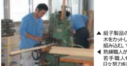
▲組子製品の製作風景。木をカットし、切れ目を入れ、組み込む。すべて手作業だ。熟練職人が活躍する一方で、若手職人も技術力向上に日々努力を重ねる
