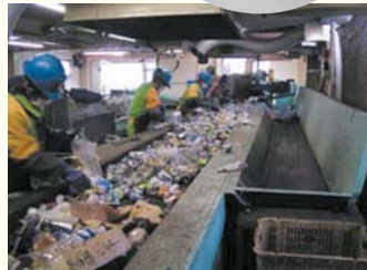
▲缶類の分別工程（オガワエコノスの資料より）
