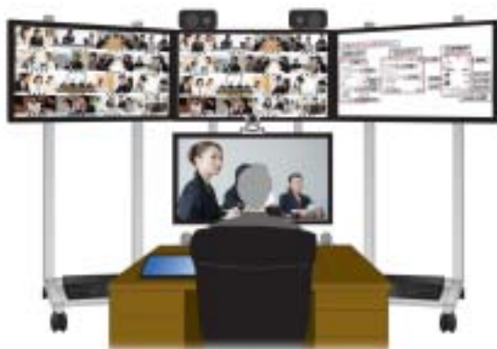
「Live VC Navi」の構成例。メインユニットは上下2画面構成とし、左横に映像用、右横に共有資料表示用の増設ユニットを配している
