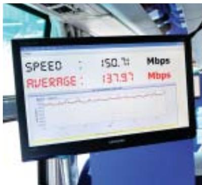
フィールドテストは東京都千代田区のKDDI大手町ビルに設置した基地局から、その周辺を走行する大型バス映像データを送信する形で行われた。静止状態では150Mbps程、走行時も100Mbps前後の実効速度が得られることが示された
