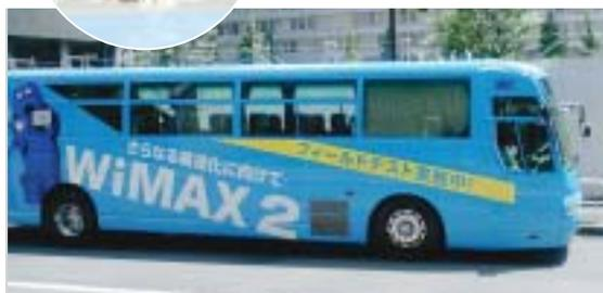
WiMAX 2では4対のアンテナを利用して通信速度を向上させる空間多重技術の4×4MIMOが使われる。試験車両の屋根には4本のアンテナが確認できる
