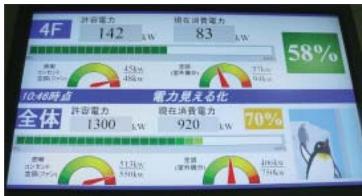
NECネットエスアイのオフィスに設置された電力見える化のモニター。フロアと全社の状況が、空調室外機と照明・コンセント等に分けて表示されている
